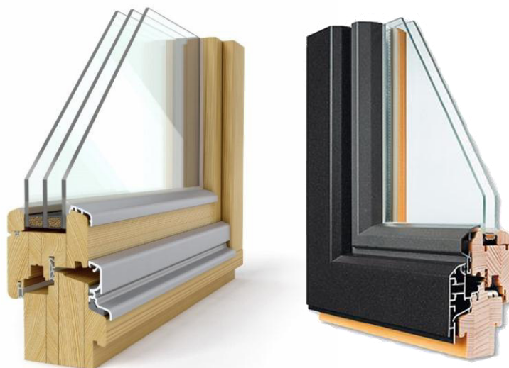
6.1.7.1. ábra: Fából készült ablak háromszoros üvegréteggel, valamint külső alumínium borítással rendelkező fából készült ablak.
